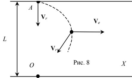
координат с аналитическим решением  $r = \frac{L}{\sin \varphi} \operatorname{tg}^k \frac{\varphi}{2}$ , где  $\mathbf{r}$  – радиус вектор, соединяющий точку на берегу и пловца,  $\varphi$  – угол между  $\mathbf{r}$  и осью  $x$ , а  $k = v_r/v_e$ .
